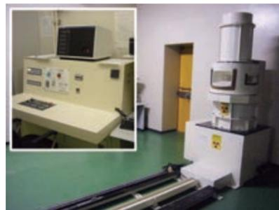
低線量・低線量率放射線照射装置
